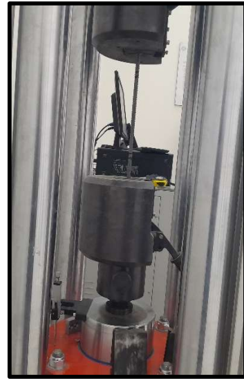
Steel Bar Tensile Test.
